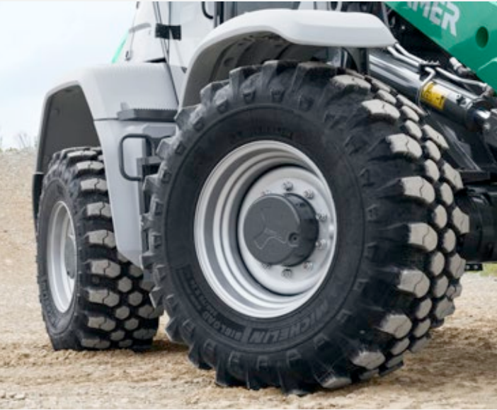
Skrętne koła przedniej osi idealnie nadają się do pracy z przyczepą
